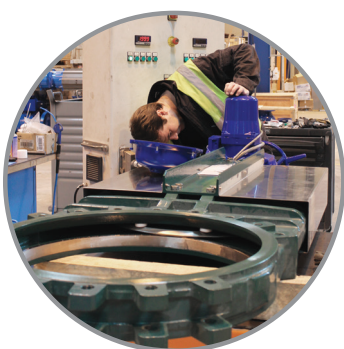
Montage et réglage de moteur électrique sur vanne à guillotine DN 500.
