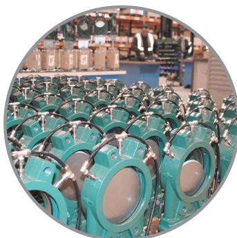
Vannes guillottes DN 150 à vérin pneumatique avec trous de soufflage pour alimentation d'air.
