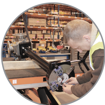
Montage et réglage de contacts fin de course sur réducteur déporté pour boisseau sphérique inox 3 voies DN 80
