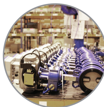
Vannes papillon équipées de vérin pneumatique double effet avec commande manuelle de secours.
